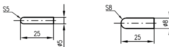
Obr. 4-12 Geometrie projektilů pro rychlý dynamický test.
