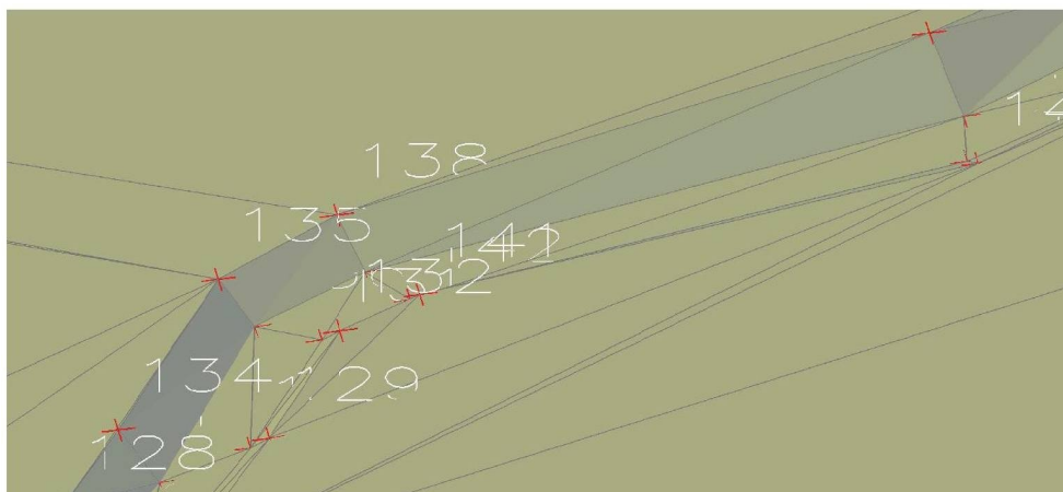
Obrázek 14.: TIN povrch po použití povinných spojnic [vlastní]
