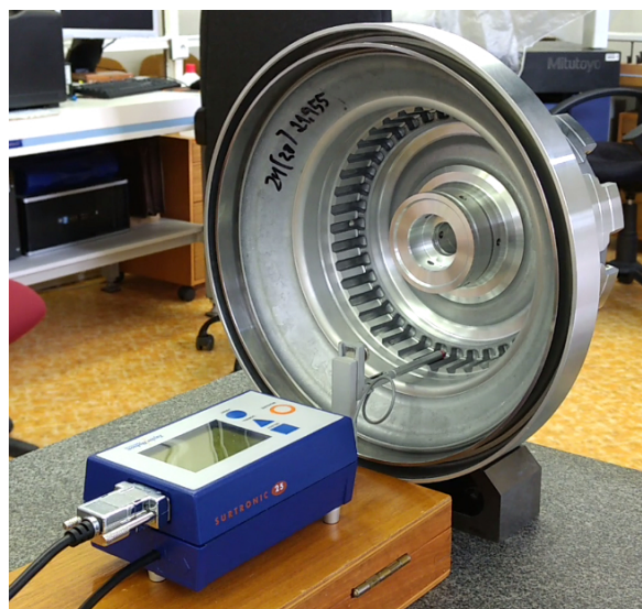
Obr. 39) Měření profilu vrcholů drážek těla převodníku krouticího momentu pomocí profilometru Surtronic 25
