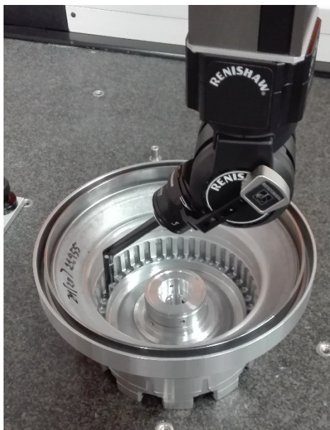
Obr. 40) Měření profilu vrcholů drážek těla převodníku kroticího momentu pomocí sondy SFP2
