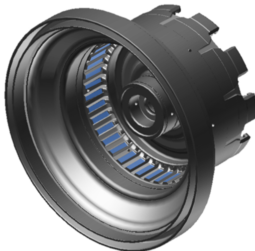
Obr. 38) Tělo převodníku kroučicího momentu se zvýrazněnými kontrolovanými plochami vrcholů drážek
