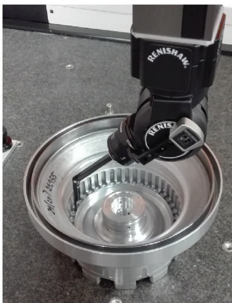
Obr. 40) Měření profilu vrcholů drážek těla převodníku krouticího momentu pomocí sondy SFP2
