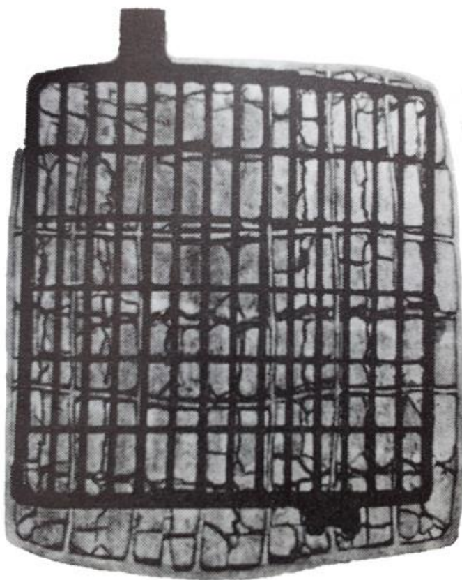
Obr. 17 Rozpínání aktivní hmoty v mřížkových elektrodách [7]
