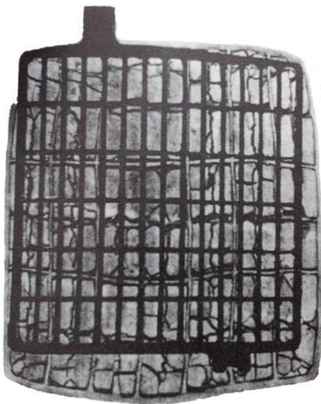
Obr. 17 Rozpínání aktivní hmoty v mřížkových elektrodách [7]
