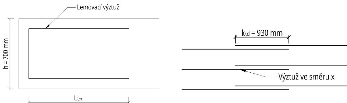
Obr. 4-22: Lemovací výztuž, stykování výztuže
