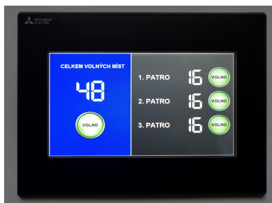
Obrázek 7.3: Operátorský panel při úplně neobsazeném parkovišti
