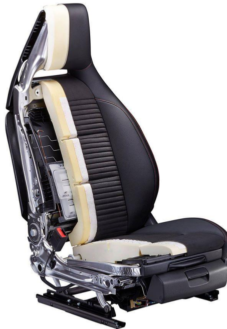
Obrázek 5: Průřez autosedačkou (Zdroj: Adient Czech Republic, s. r. o.)
