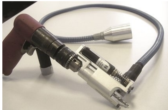
Obr. 25 Geometrie vrtáku Fishtail [38] Obr. 26 Patentovaný kompenzátor posuvu [38]
