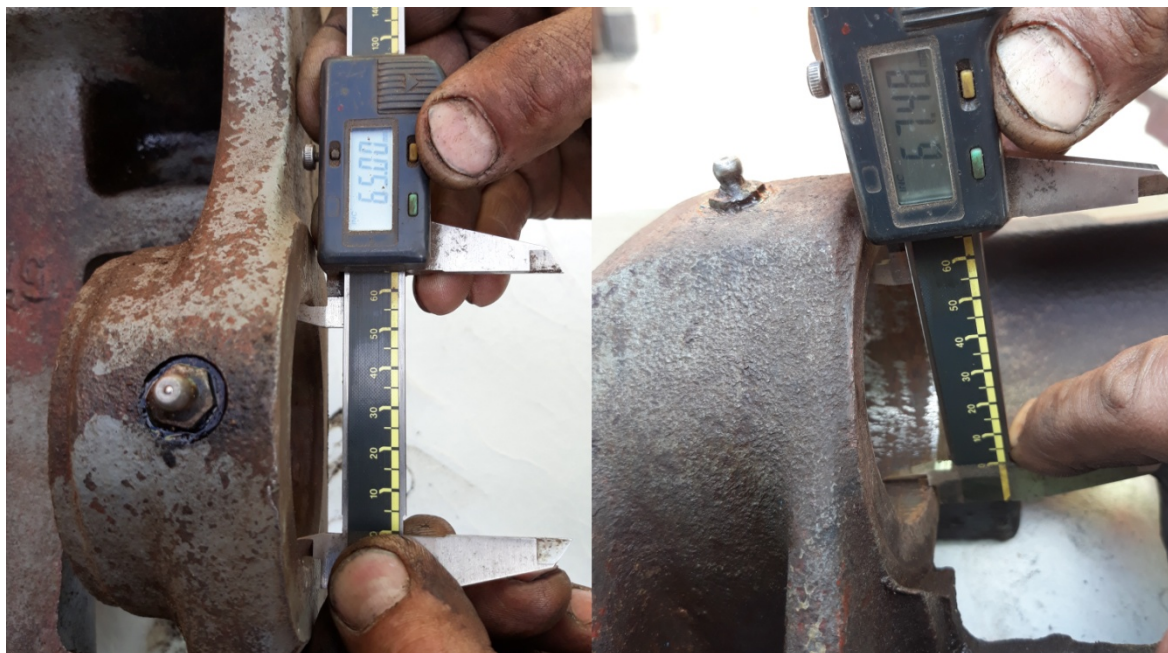
Obr. 53 Rozměry děr pro uložení čepu před renovací.
