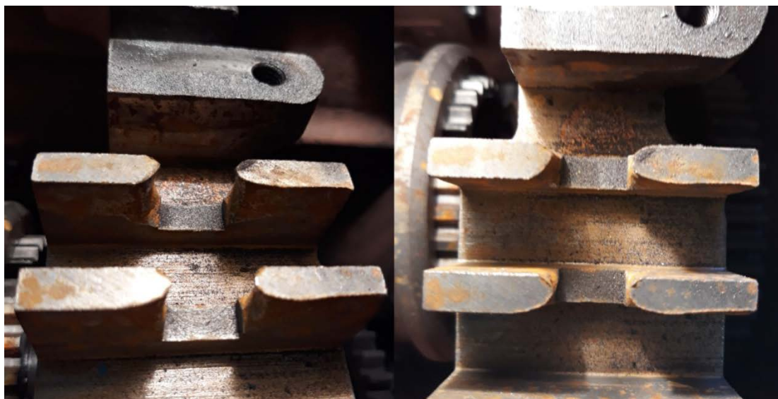
Obr. 60 Opotřebení vodicích drážek v převodové skříně
