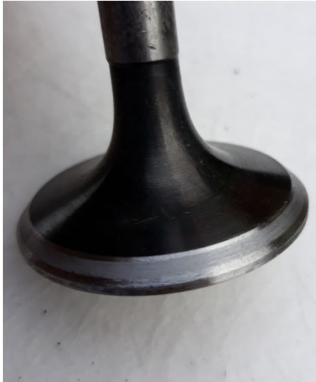
Obr. 56 Stopa po zabroušení na výfukovém ventilu
