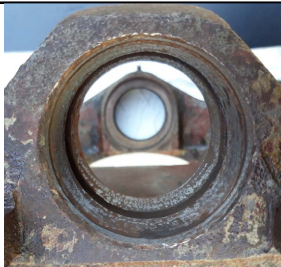
příprava otvoru před navařením
