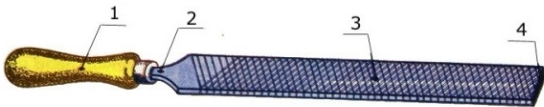
Obr. 16 Hlavní části pilníku: 1 - rukojeť, 2 - stopka, 3 - tělo(list), 4 - hlava [23]
