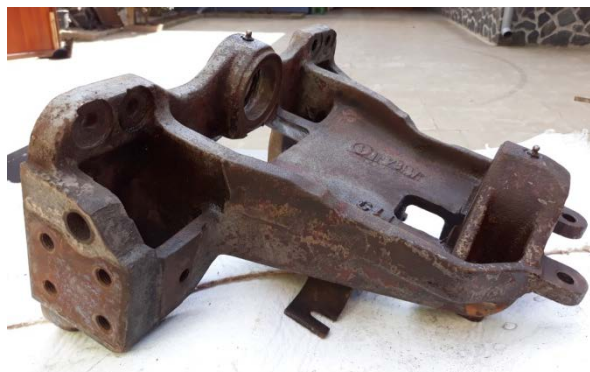
výchozí stav - konzola je demontována a připravena k renovaci
