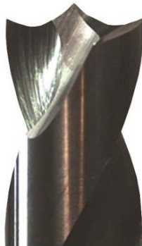
Obr. 25 Geometrie vrtáku Fishtail [38] Obr. 26 Patentovaný kompenzátor posuvu [38]
