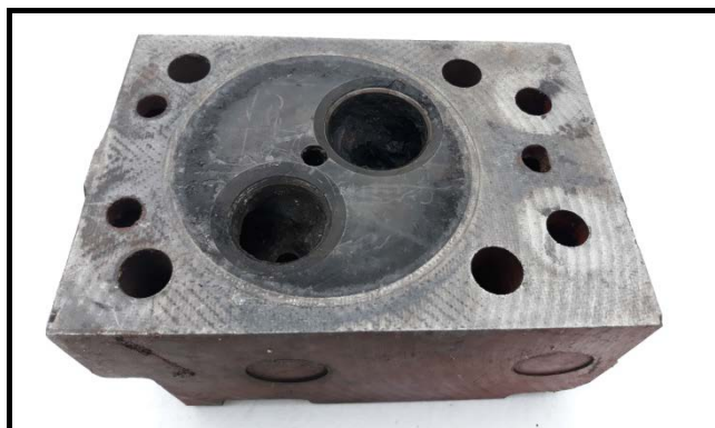
výchozí stav - hlava je demontována a připravena k renovaci
