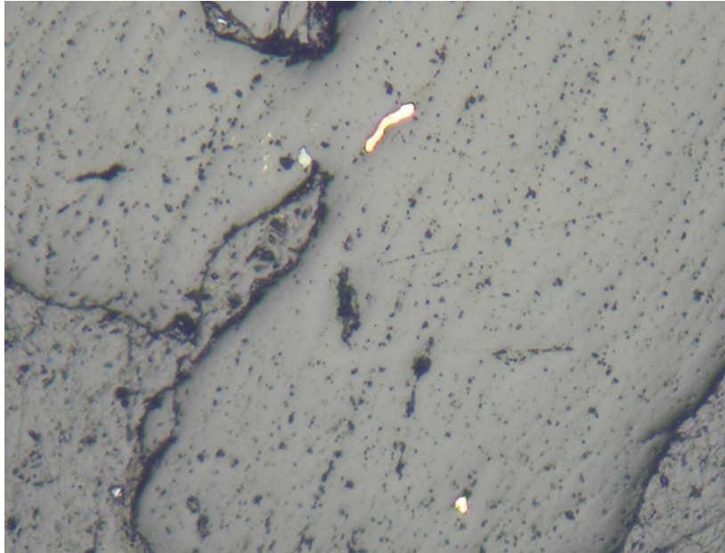
Obr. 30. Zlato v křemeni ze žiloviny s limonitizovaným pyritem (není zachycen v ploše snímku), šířka pole 0,8 mm. Vzorek č. 1. Nábrus, odražené světlo (foto: V. Bártková).
