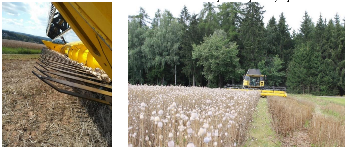
Obrázek č. 8: Sklízecí mlátička New Holland CX 8.90 s adaptérem upraveným pro sklizeň máku
