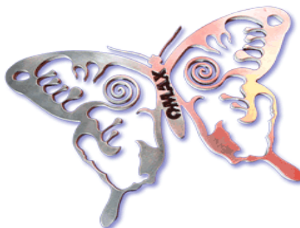
Obr. 3.31 Ukázka složitějších tvarových dílců zhotovených AWJ metodou [36,37]
