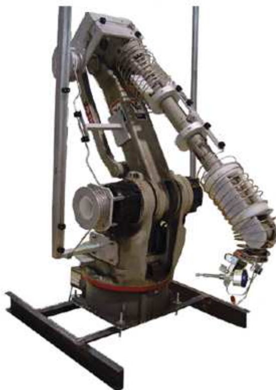
Obr. 4.41 Příklad robotické ruky s řezací hlavou na konci [26]
