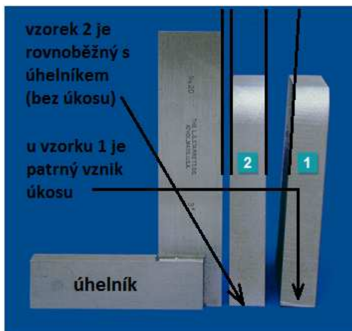
Obr. 1.36 Srovnání přesnosti metod WJM a DWJ [5]
