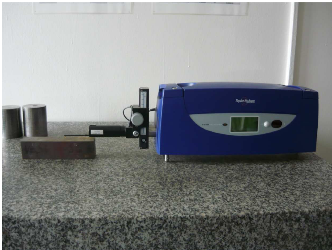
Obr. 3.44 Měření struktury povrchu přístrojem Talysurf Intra 50
