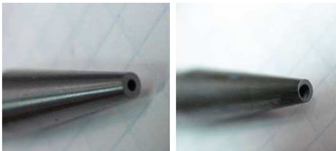
Obr. 2.22 Opotřebení zaměřovací abrazivní trysky[12]
