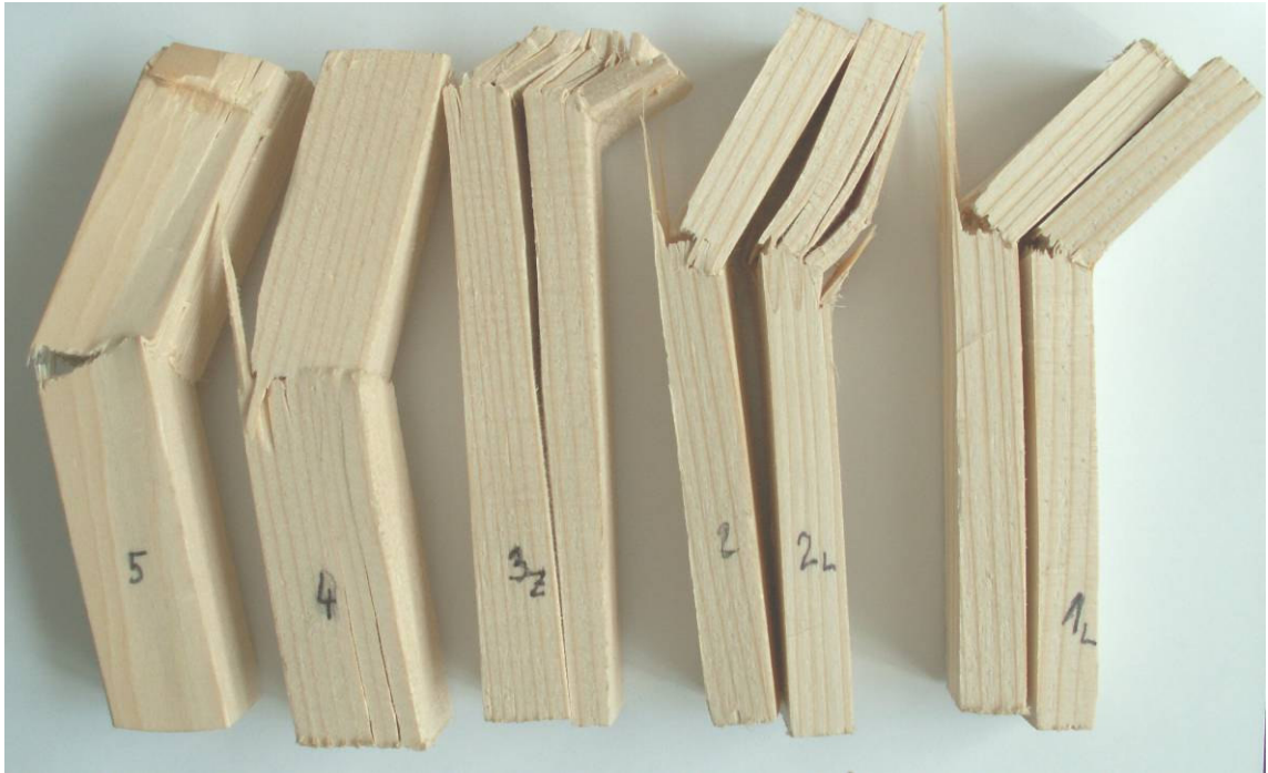
Obr. 10: Způsoby porušení vzorků 1-5. Vzorky označené L a Z byly lepené.
