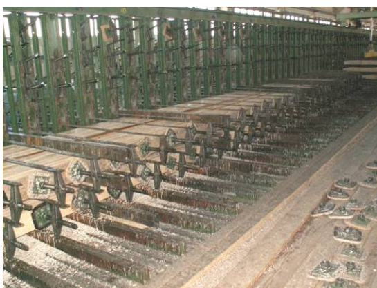
foto č.7 slepený stažený vazník
