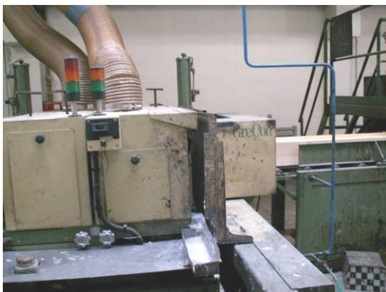
foto č.3 cinkovací stroj
