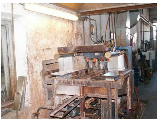
foto č.5 nanášecí zařízení (lamela projede skrz lepidlo)
