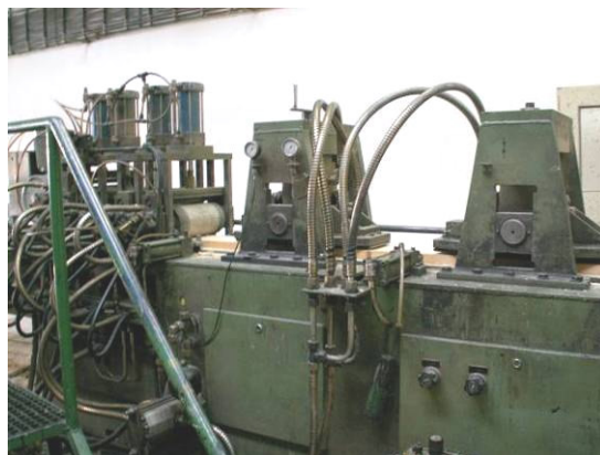
foto č.4 vytvoření tzv.nekonečného prkna z lamel s lepidlem
