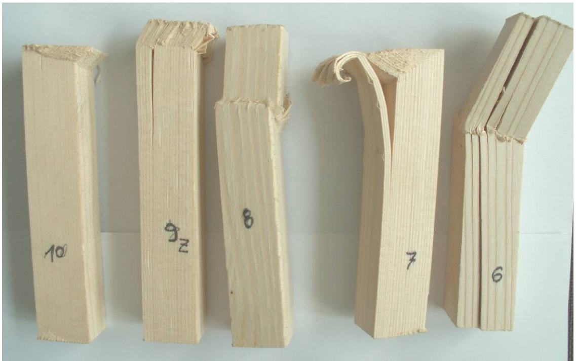
Obr. 11: Způsoby porušení vzorků 6-10. Vzorky označené L a Z byly lepené.
