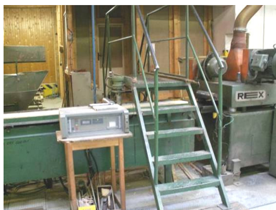
foto č.2 měření vlhkosti a zjištění nevyhovujících částí s vyznačením a následným odstraněním
