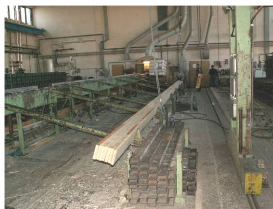
foto č.6 lamely s naneseným lepidlem (neslepený vazník)
