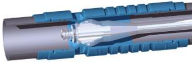
Obr. 2-9: Zafixování hlavy měřidla v teleskopické spojce (www.soilexperts.com)
