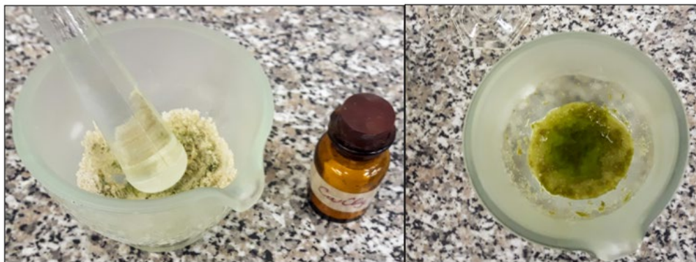
Obr. 16. Salát na menší kousky s přidáním křemenného písku a MgCO_3 (vlevo) | Do homogenní kaše byl přidán aceton (vpravo)
