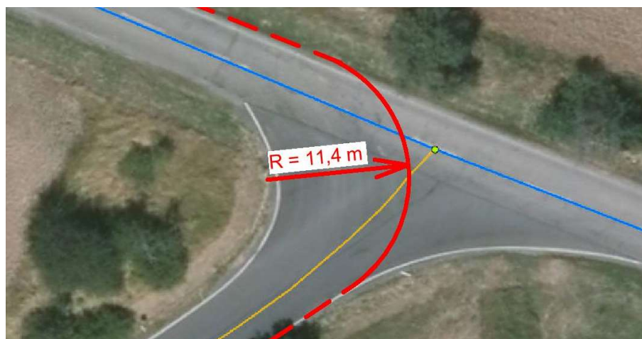
Obrázek C.2.2-2 – Bod zájmu č.1, trasa čerstvé betonové směsí a štěrkodrtí (zdroj [5])
