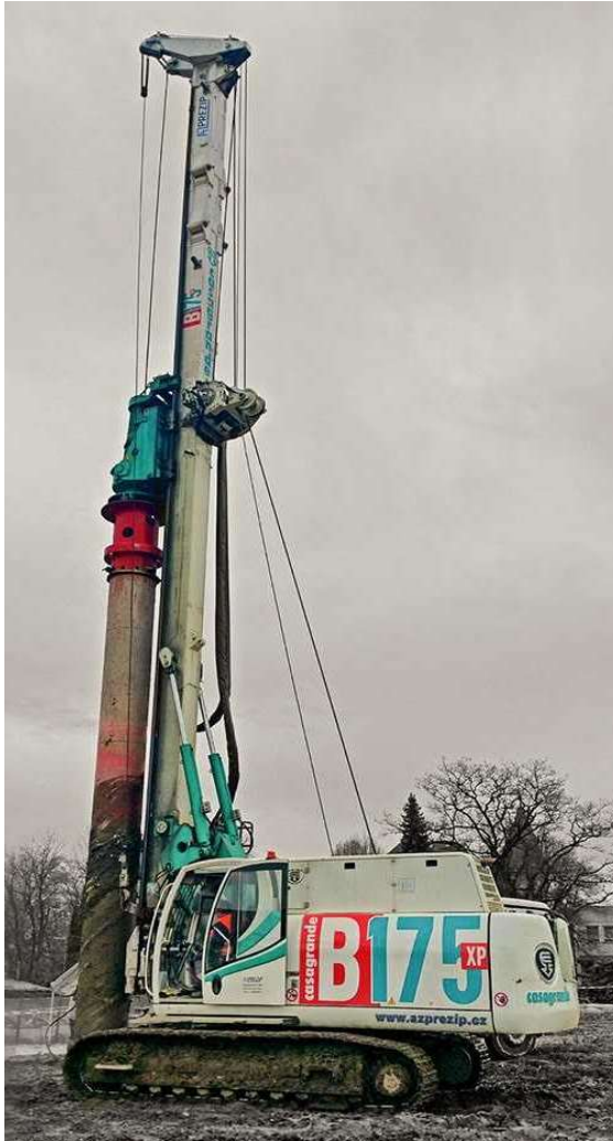
Obrázek G.2.2.1-1 – Vrtná souprava Casagrande B175 XP-2 a její pracovní rozměry ve verzi s průběžným šnekem v provedení quick (zdroje [30], [31])
