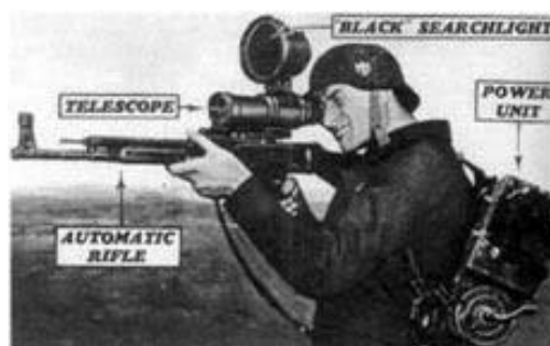
Obrázek 2: Vampir ZG 1229, připnutý na útočnou pušku StG 44
