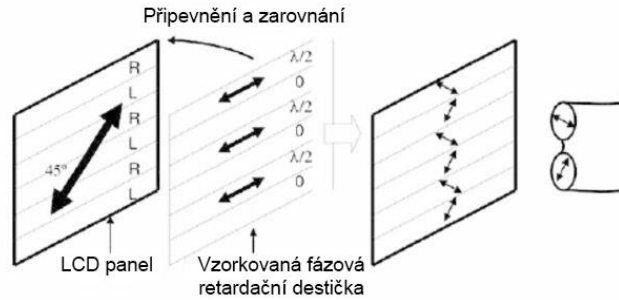
Obr. 7 Stereoskopický 3D displej využívající lineární polarizaci [5]
