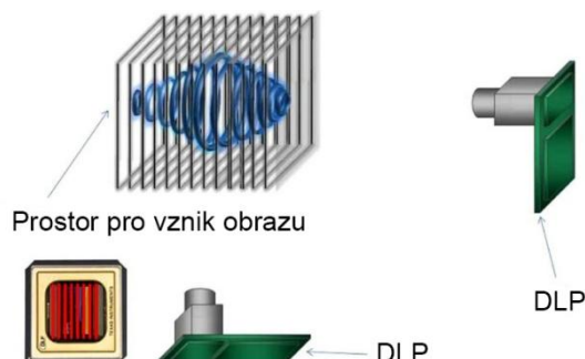
Obr. 25 Princip adresace a vzniku obrazu [20]
