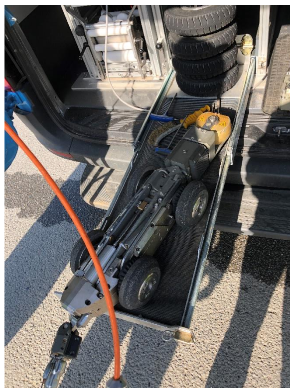
Obr. 21 Kamerový vozík s navijákem osazený rotační a výkyvnou kamerovou hlavou [zdroj foto: V. Palkovská]
