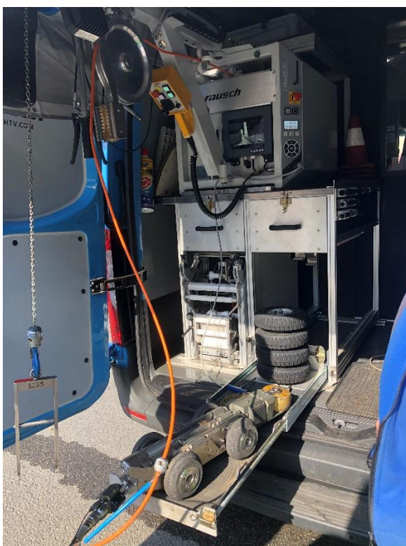
Obr. 20 Vestavba RAUSCH [zdroj foto: V. Palkovská]
