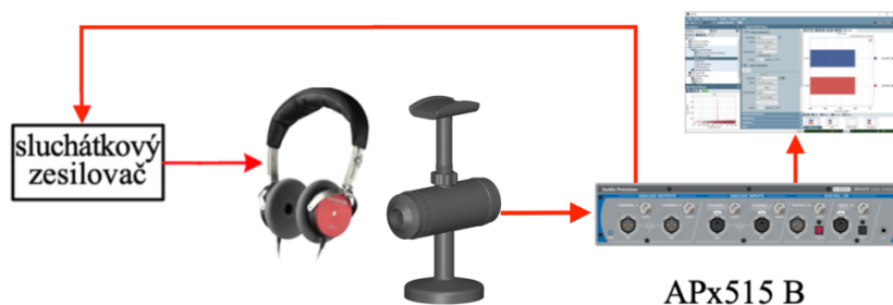
Obr. 3.23 Pracoviště pro měření kmit. char. na vlastním přípravku s APx515.
