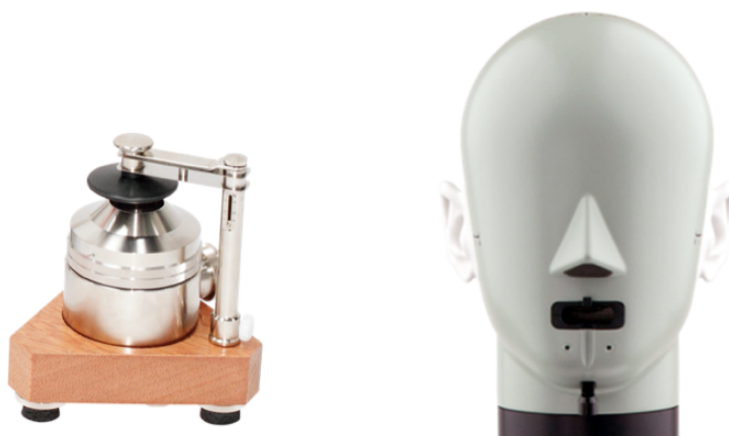
Obr. 3.19 Simulátor ucha (vlevo) [8] a HATS (vpravo) [13].
