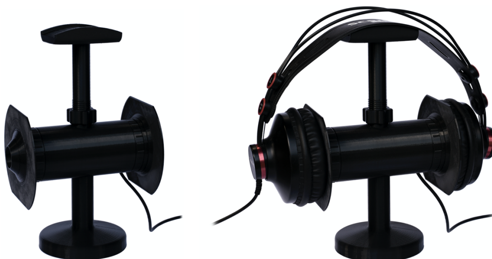
Obr. 3.17 Měřicí přípravek pro měření sluchátek s uzavřeným objemem.
