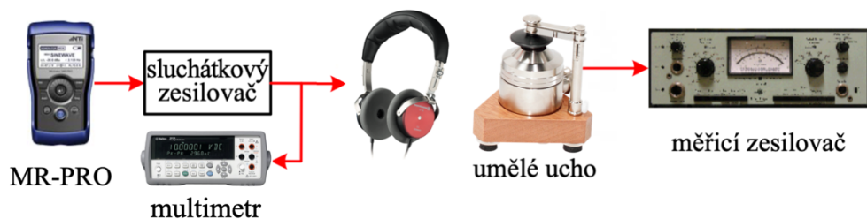
Obr. 3.22 Pracoviště pro měření kmit. char. na simulátoru umělého ucha.
