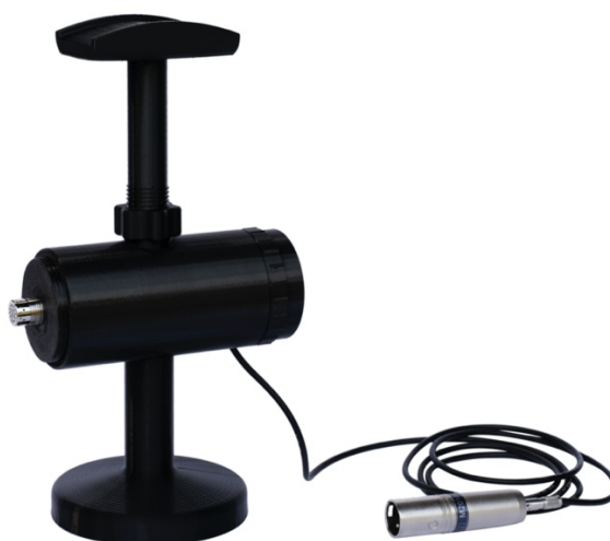
Obr. 3.15 Měřicí přípravek s umístěným mikrofonom.
