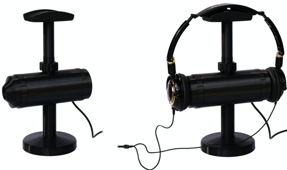
Obr. 3.16 Měřicí přípravek pro měření náušních sluchátek
