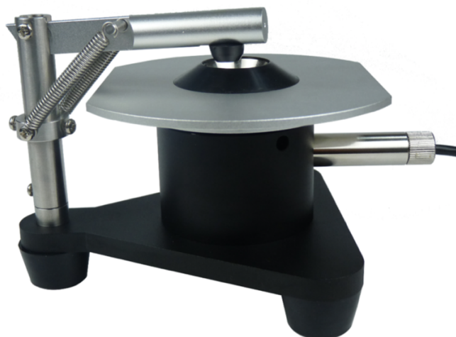
Obr. 2.5 Simulátor ucha s adaptérem pro sluchátka s uzavřeným objemem [9].
