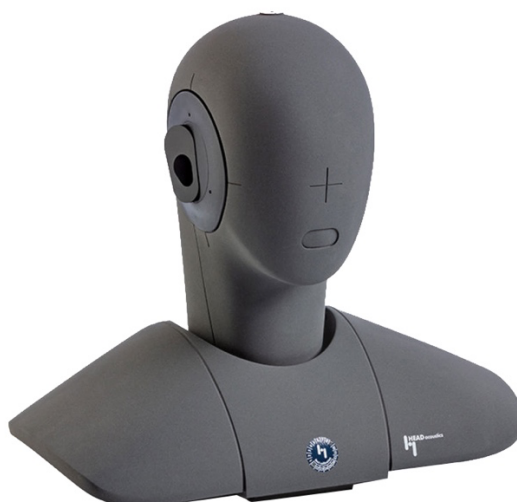
Obr. 2.11 Simulátor boltce (zjednodušený) [14].
