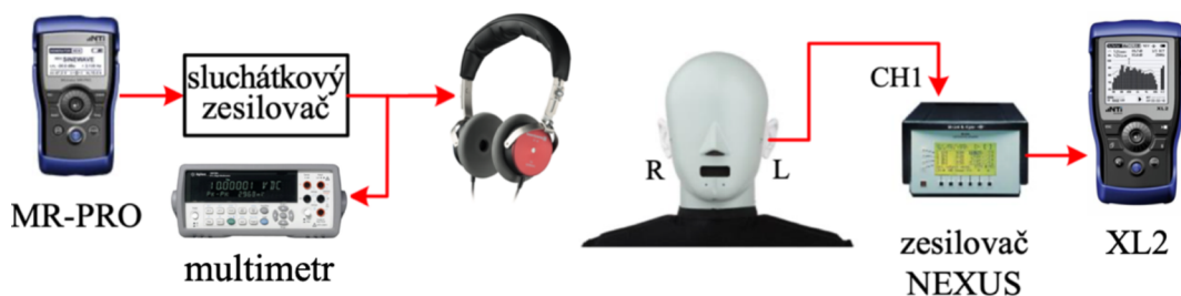
Obr. 3.21 Pracoviště pro měření kmit. char. na HATS.
