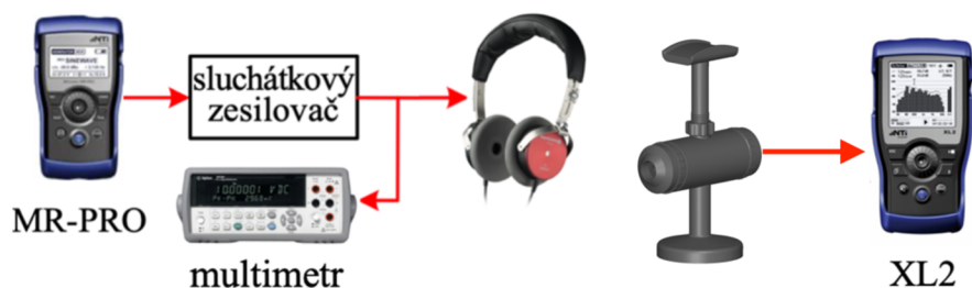
Obr. 3.20 Pracoviště pro měření kmit. char. na vlastním přípravku.
