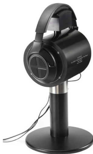
Obr. 3.2 Akustický zkušební přípravek [17].
