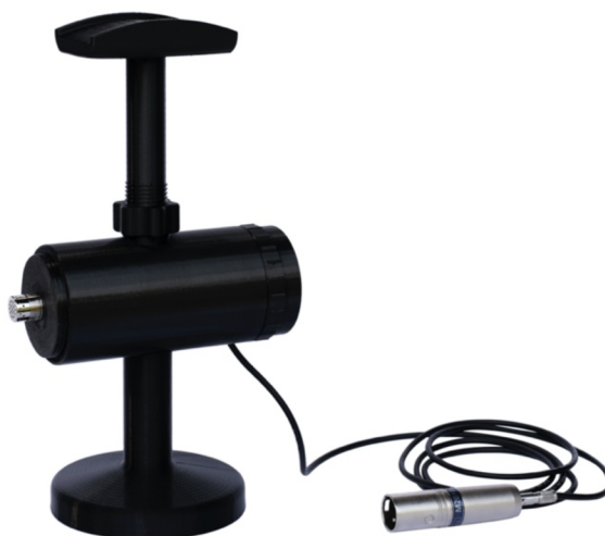
Obr. 3.15 Měřicí přípravek s umístěným mikrofonom.
