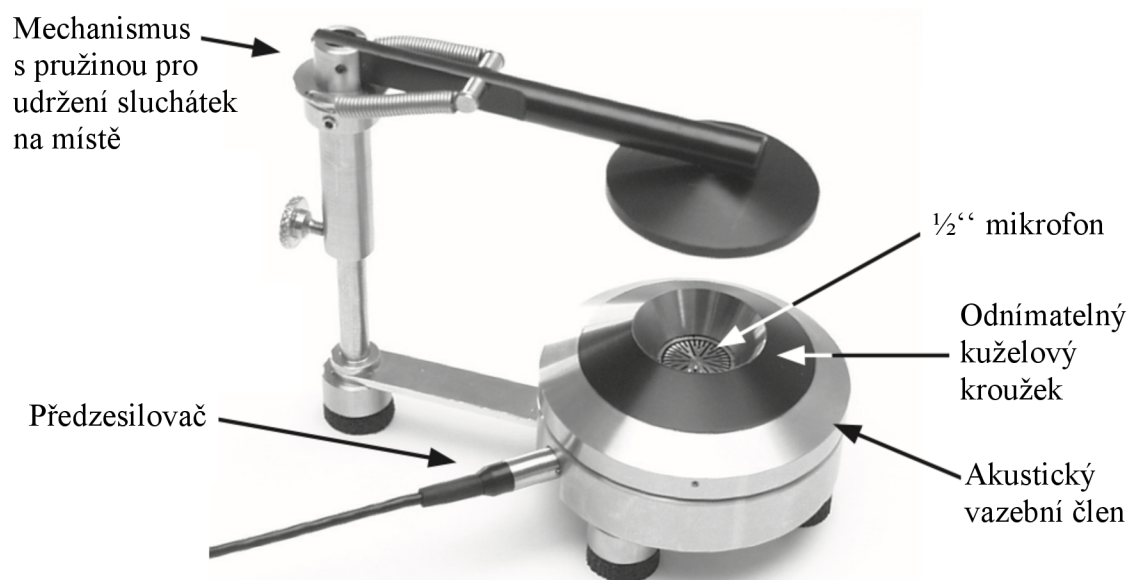
Obr. 2.1 Simulátor ucha: Typ 1 [7].
