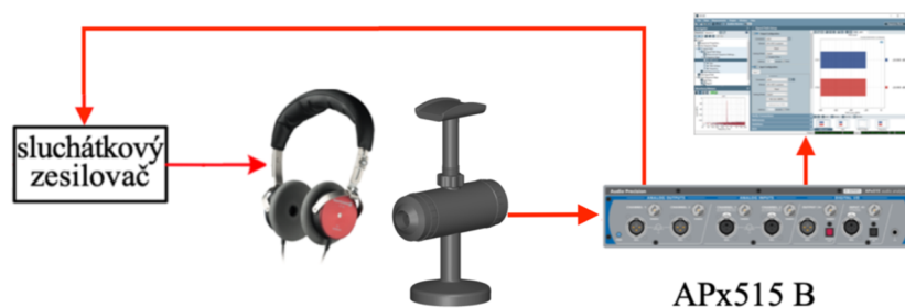
Obr. 3.23 Pracoviště pro měření kmit. char. na vlastním přípravku s APx515.
