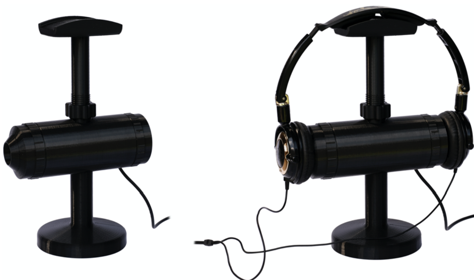
Obr. 3.16 Měřicí přípravek pro měření náušních sluchátek
