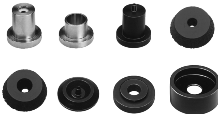
Obr. 2.8 Adaptéry simulátoru ušního nástavce [11].
