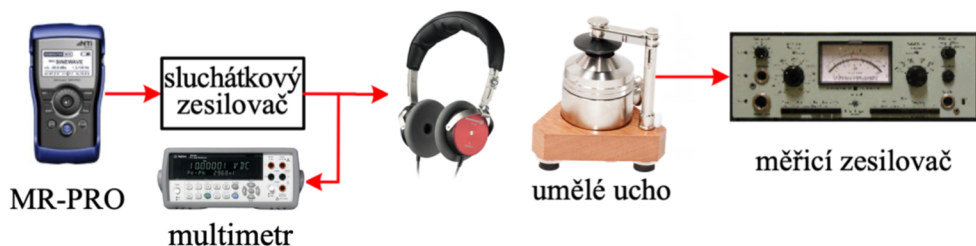
Obr. 3.22 Pracoviště pro měření kmit. char. na simulátoru umělého ucha.
