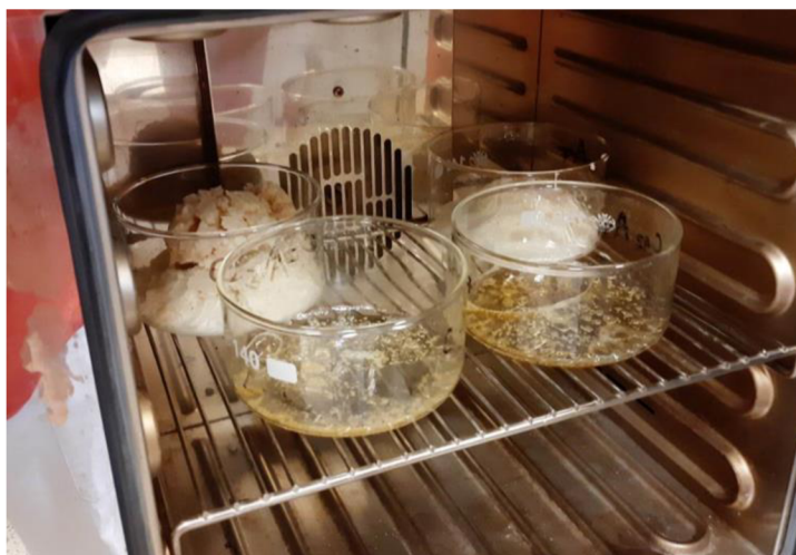
Obrázek 9: patrný rozdíl mezi amorfním gelem po odpaření a vznikajícím xerogelem (vzadu)
