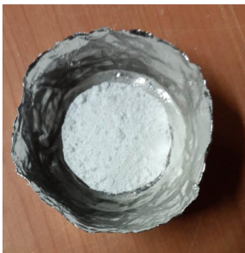
Obrázek 10: vypálená fáze VT metodou v platinové misce před rozemletím
