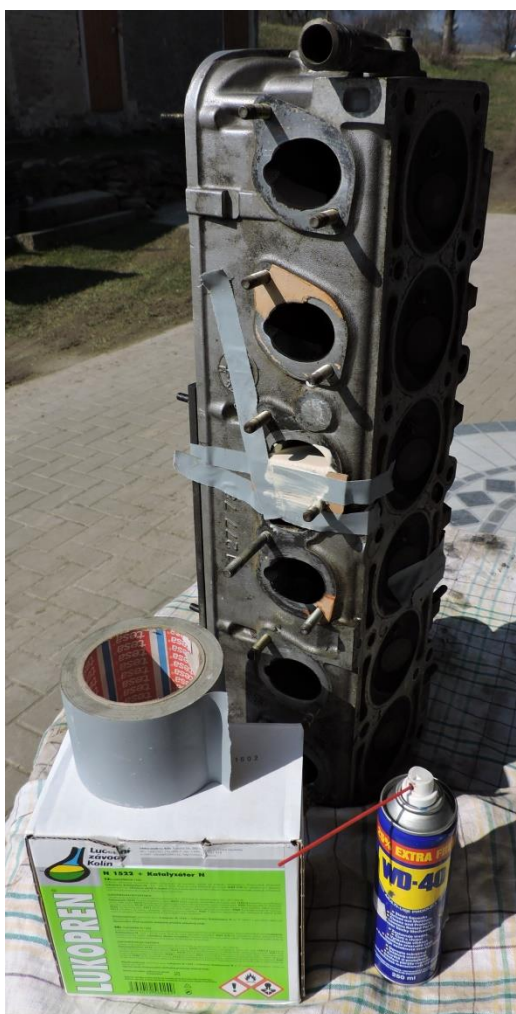
Obr. 7.7 Odlévání kanálů v hlavě válců.
