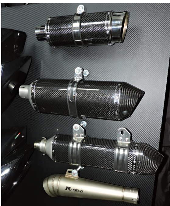
Obr. 1.11 Tlumiče hluku s pláštěm z kompozitních materiálů
