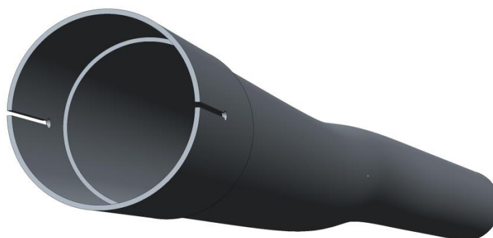
Obr. 11.2 Model zadní části spojovacího potrubí, pohled na přírubu pro spojení s přední částí spojovacího potrubí
