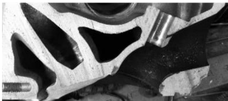
Obr. 1.1 Řez hlavou motoru M20 B20 (B23)[16]
