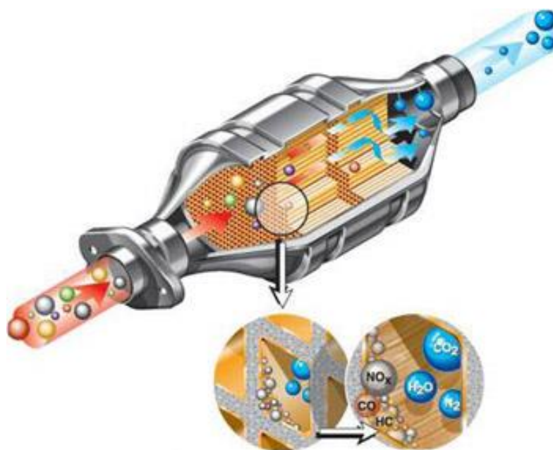
Obr. 1.7 Schematický řez katalyzátorem [18]
