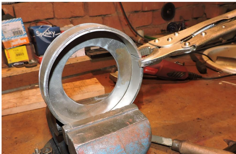
Obr. 10.2 Výroba čela experimentálního tlumiče hluku – upnutí před svařením
