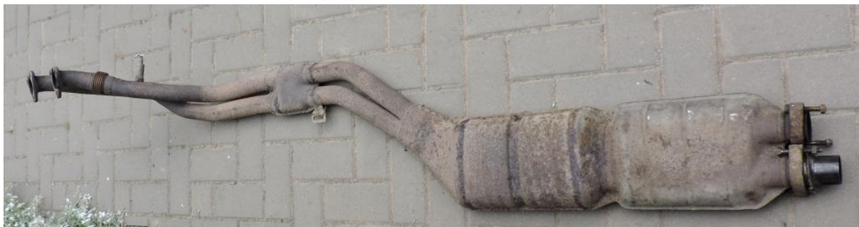
Obr. 1.4 Spojovací potrubí a katalyzátor sériového výfukového potrubí BMW
