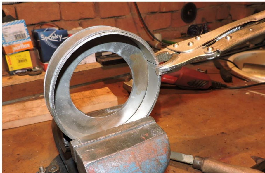
Obr. 10.2 Výroba čela experimentálního tlumiče hluku – upnutí před svařením
