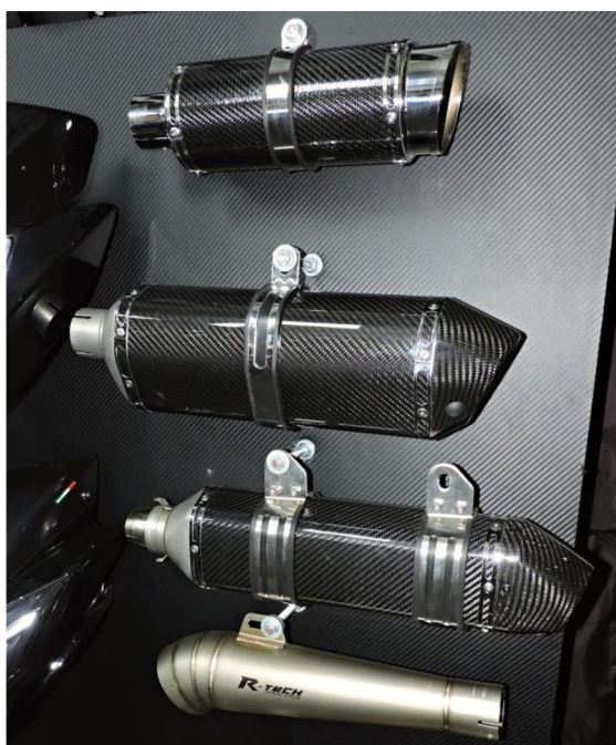
Obr. 1.11 Tlumiče hluku s pláštěm z kompozitních materiálů
