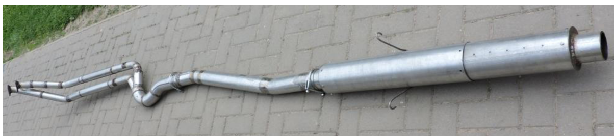
Obr. 11.5 Smontovaný výfukový systém s experimentálním tlumičem hluku o délce 900 mm - varianta „A“
