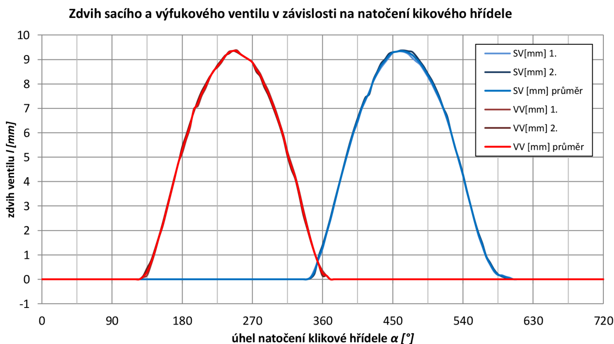
Graf 7.1 Průběh zdvihu ventilů v závislosti na natočení klikového hřídele
