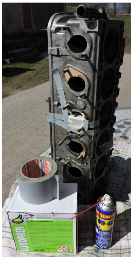
Obr. 7.7 Odlévání kanálů v hlavě válců.
