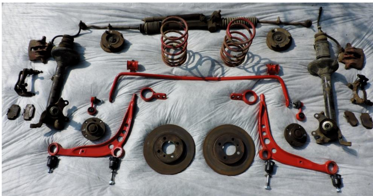
Obr. 6.2 Komponenty přední nápravy, řízení a brzdového systému předních kol vozu BMW 320i E 30
