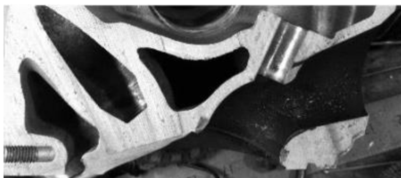
Obr. 1.1 Řez hlavou motoru M20 B20 (B23)[16]
