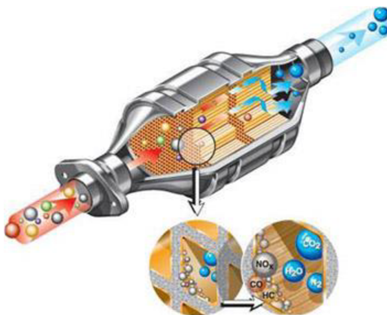
Obr. 1.7 Schematický řez katalyzátorem [18]
