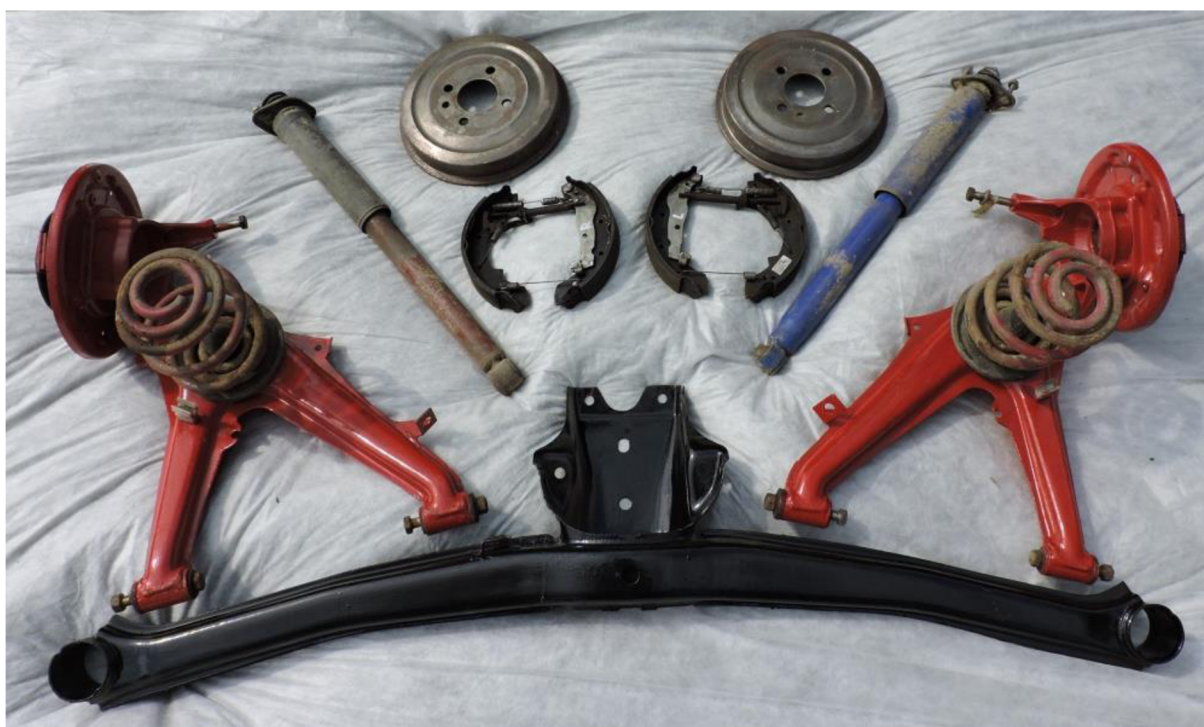
Obr. 6.3 Komponenty zadní nápravy a brzdového systému zadních kol vozu BMW 320i E 30
