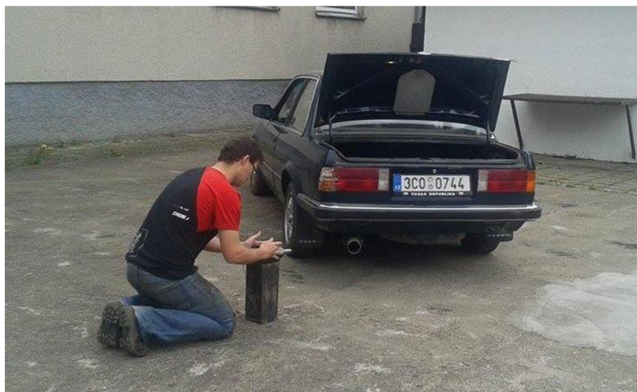
Obr. 10.5 Měření hladiny hluku podle metodiky popsané v kapitole E NSŘ
