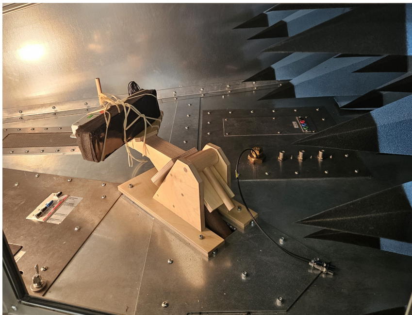
Obrázek 6.7: BMS jednotka umístěná na manipulátoru komory
