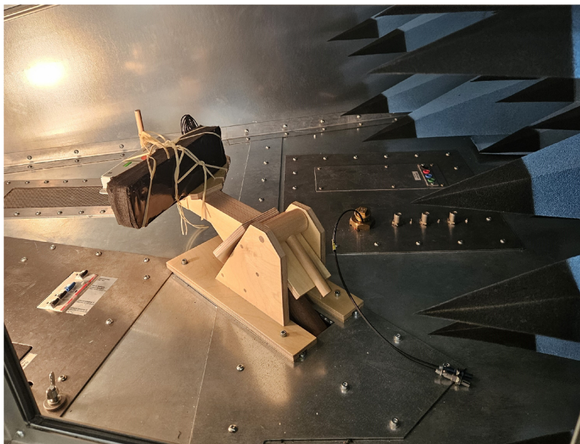
Obrázek 6.7: BMS jednotka umístěná na manipulátoru komory
