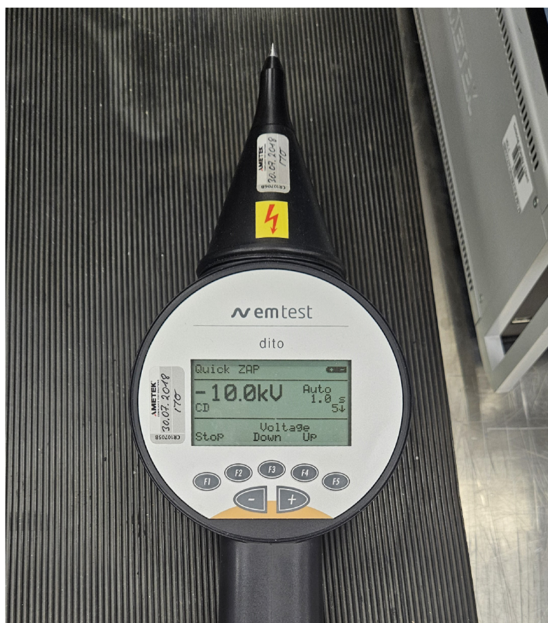
Obrázek 6.2: Generátor ESD od EMTEST s ostrým hrotem pro kontaktní výboj
