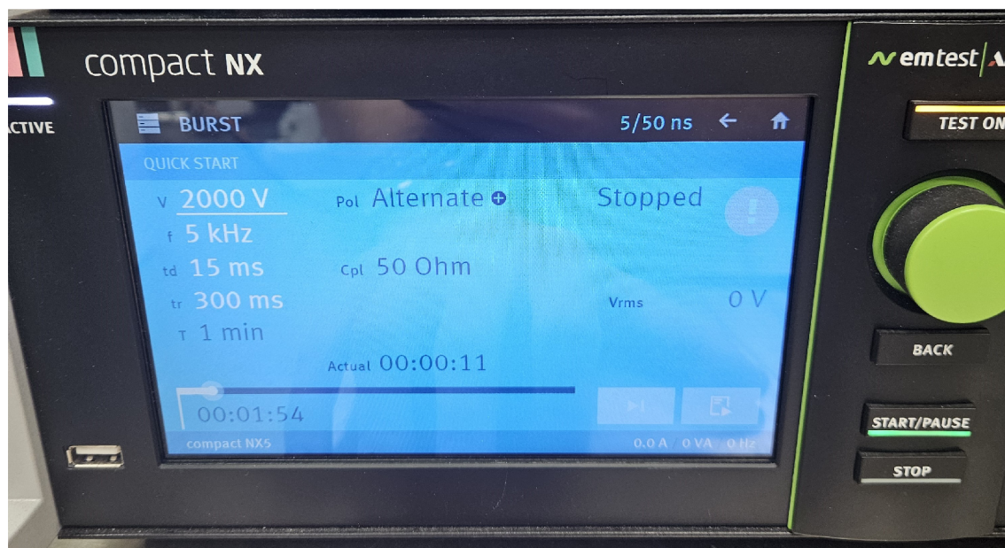
Obrázek 6.4: Generátor EFT/B od EMTEST s nastavenými hodnotami
