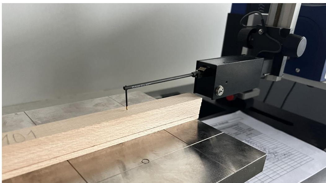
Obrázek č. 13 Měření drsnosti a vlnitosti metodou doteku pomocí hrotu na zařízení Taylor Hobson Form Talysurf 50 (Zdroj: Autor práce)
