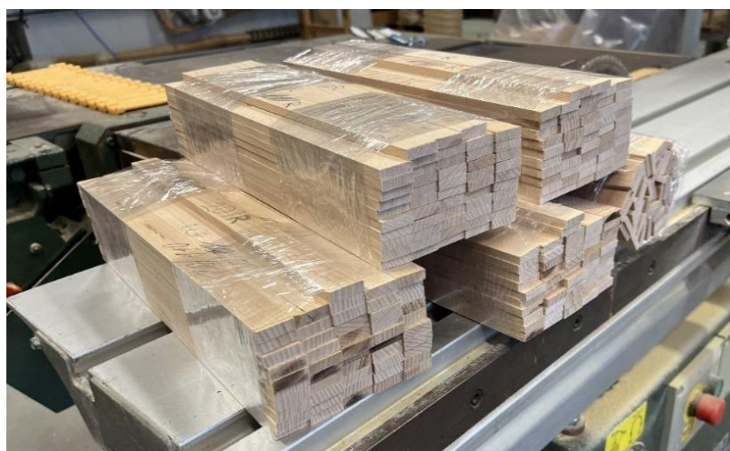
Obrázek č. 11 Zkušební vzorky rozdělené do skupin dle stupně zhuštění (Zdroj: Autor práce)
