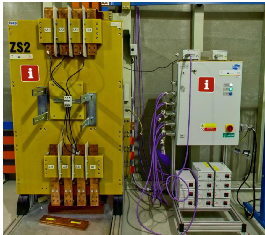
Obrázek 26: Ukázka zapojení měřícího zařízení s měřicí ústřednou a měřícími perifériemi
