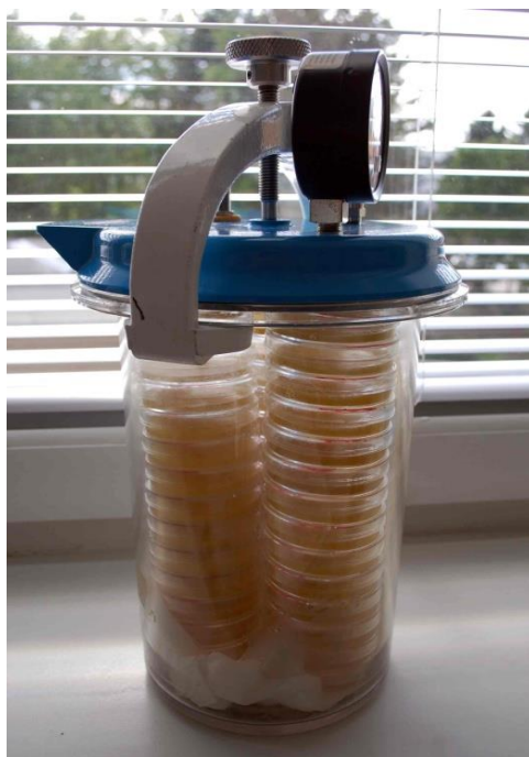
Obr. 2 Anaerobní kultivace humánních kmenů bifidobakterií v anaerostatu; foto: autor, 2017.
