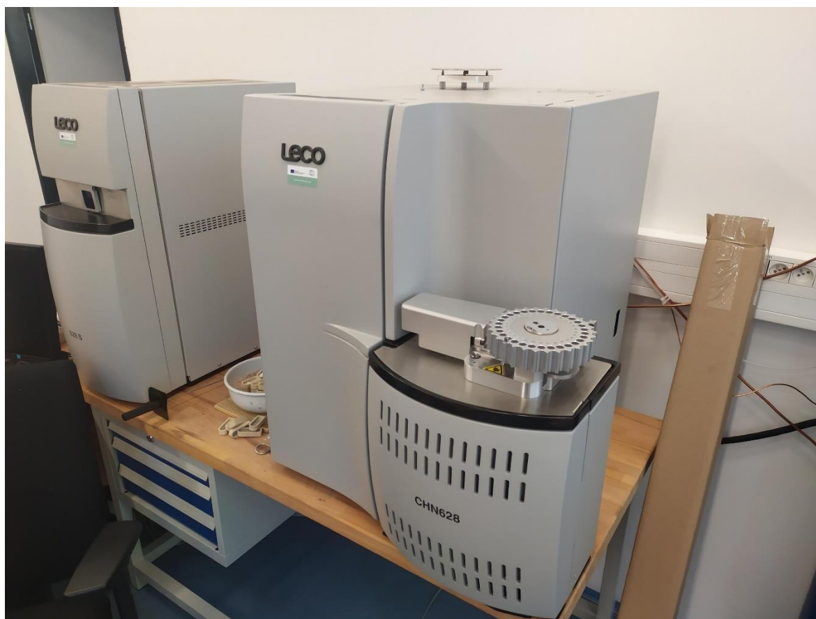
Obrázek č. 5 5.3.5 Analyzátor LECO CHN 628 s modulem pro stanovení síry
