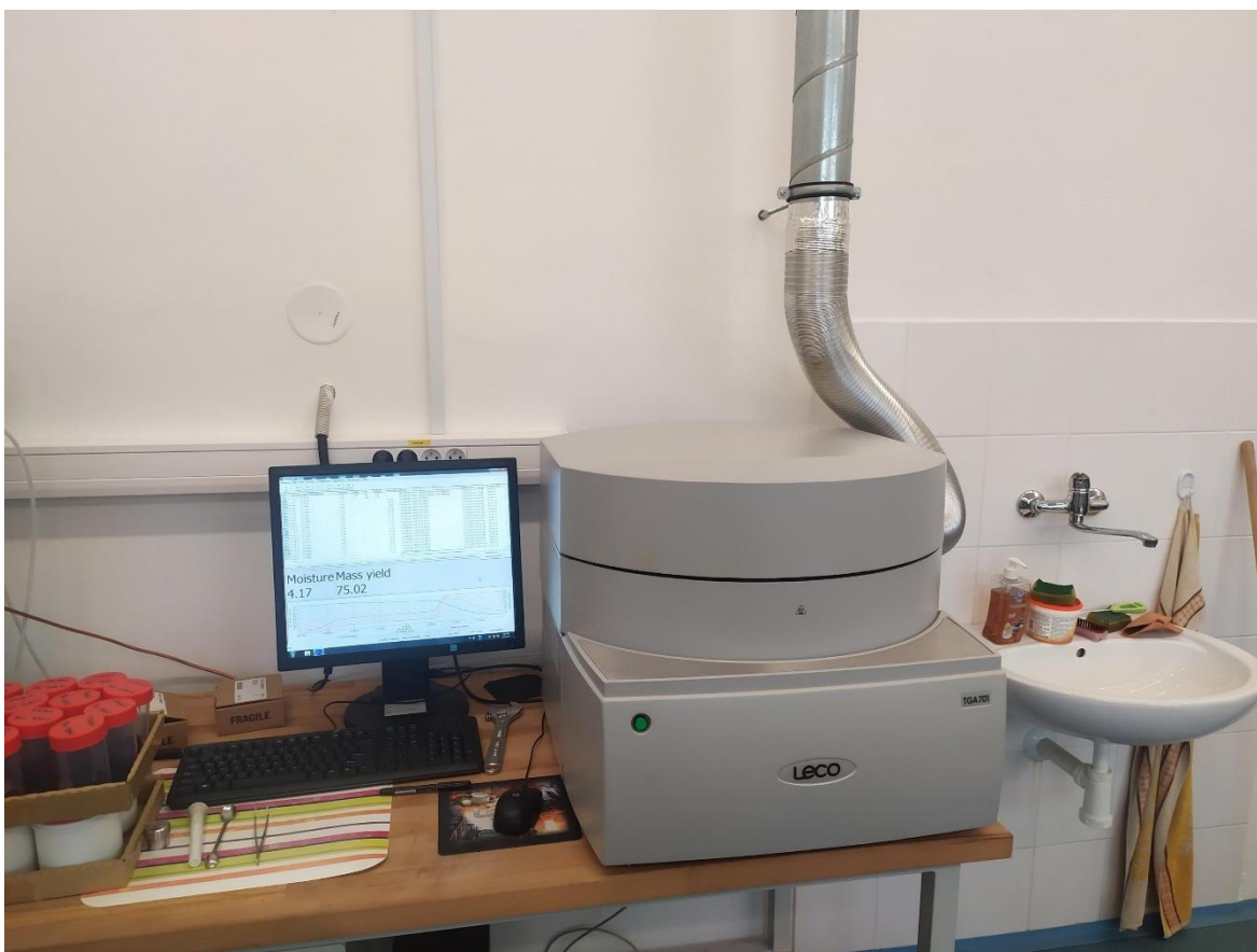
Obrázek č. 3 5.3.3 Termogravimetrický analyzátor LECO TGA-701
