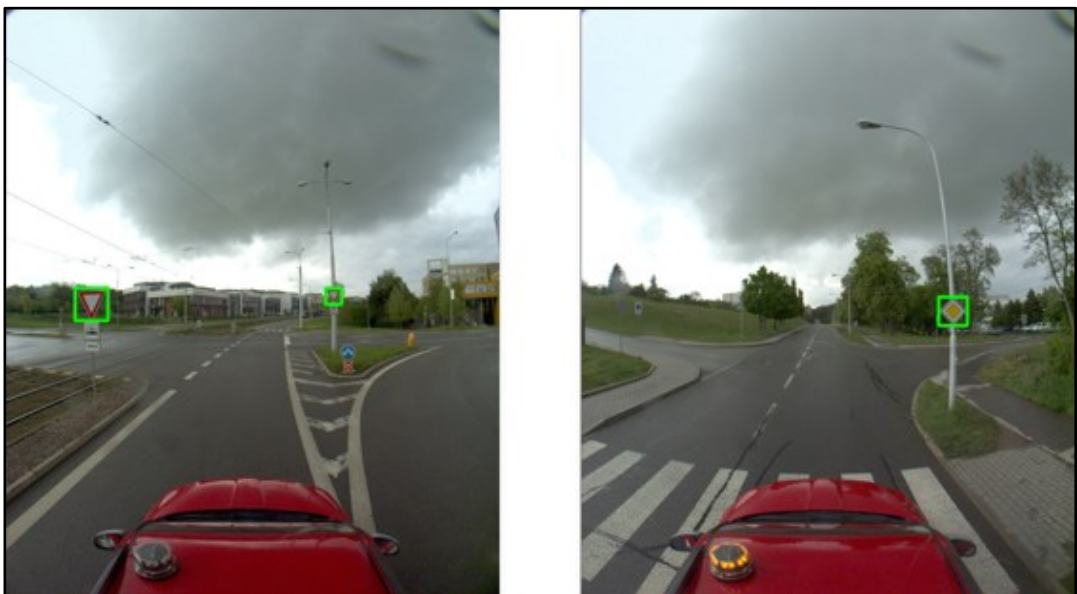
Obr. 19 Ukázka pozitivních detekcí [vlastní tvorba]
