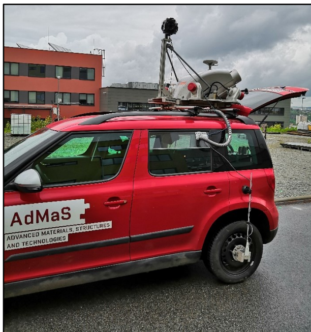
Obr. 8 Mobilní mapovací systém RIEGL VMX - 450 [vlastní tvorba]
