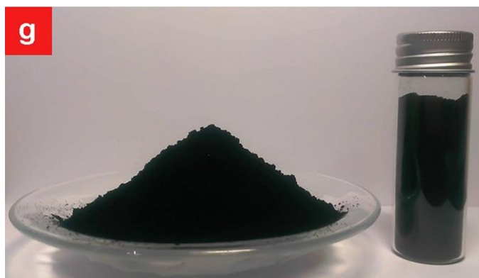
Obrázok 12: Mrazom vysušený rGO v práškovej forme [25]
