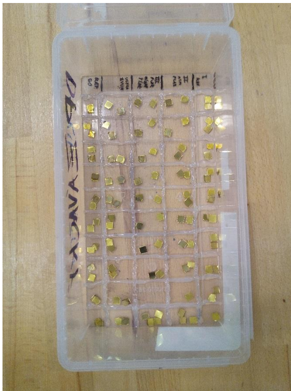
Obrázok 29: Skladovanie vzoriek a vzorky nanočastíc pre SEM
