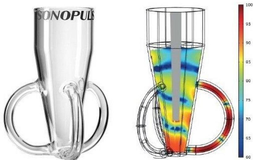
Obrázok 17: Rozetová nádoba Sonopuls a simulácia intenzity kavitácie v rozete [34]
