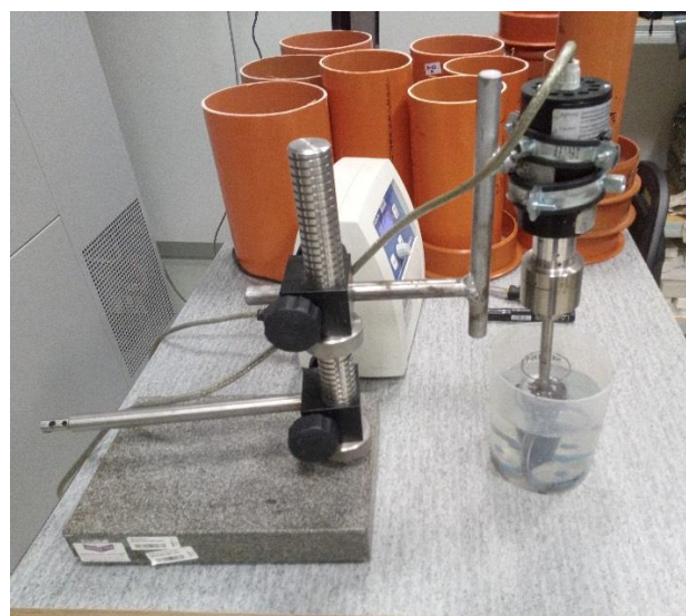
Obrázok 16: Aparatúra na sonikáciu rGO
