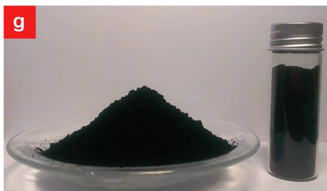
Obrázok 12: Mrazom vysušený rGO v práškovej forme [25]
