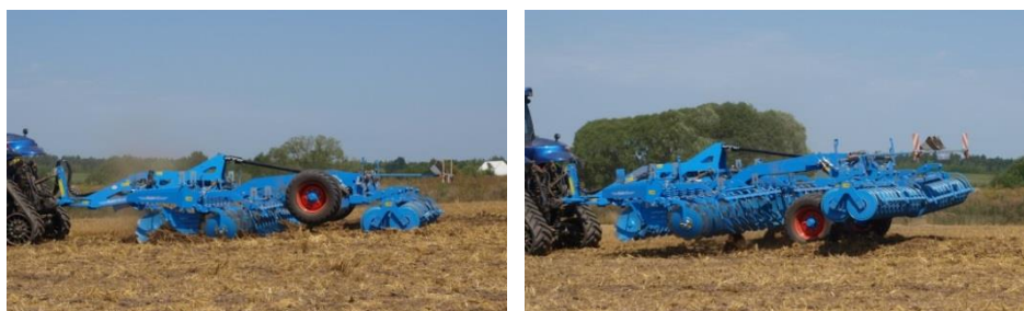
Obrázek č. 18: Zvednutí stroje na souvrati Obrázek č. 19: Zvednutí stroje na souvrati
