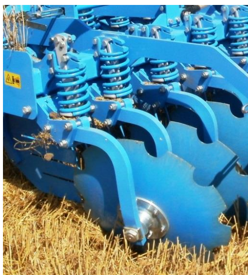
Obrázek č. 13: Pružinové jištění talířů
