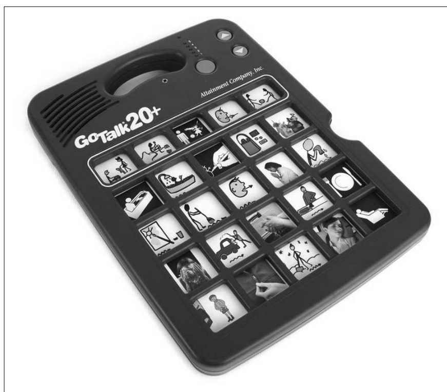
obr. č. 6 Vícevzkazový komunikátor Go Talk – přenosná pomůcka umožňující nahrávání vzkazů, výměnu obrázků v mřížkách
