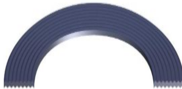
Obr. č. 12 Příklad tvaru zvlněného těsnění [17]
