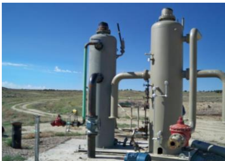
Obr. č. 3 Příklad vertikálních separátorů [7]
