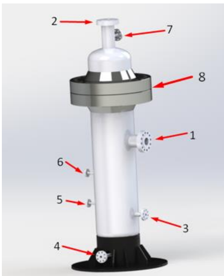
Obr.č. 27 Výsledný separátor – rozložení hrdel
