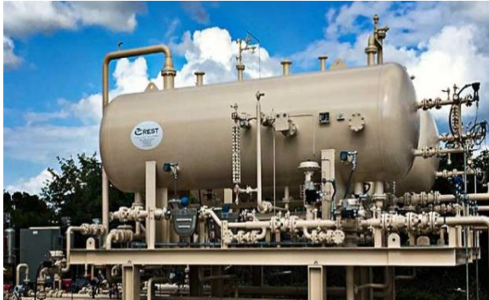
Obr. č. 4 Příklad horizontálního separátoru [8]
