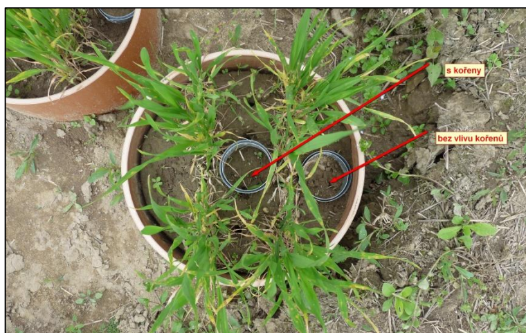
Obr. 26: Detail prstenců pro měření půdní respirace in situ (zdroj: autor)
