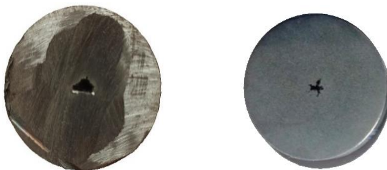
Obr. 31 Ukázka vnitřních trhlin [59].
