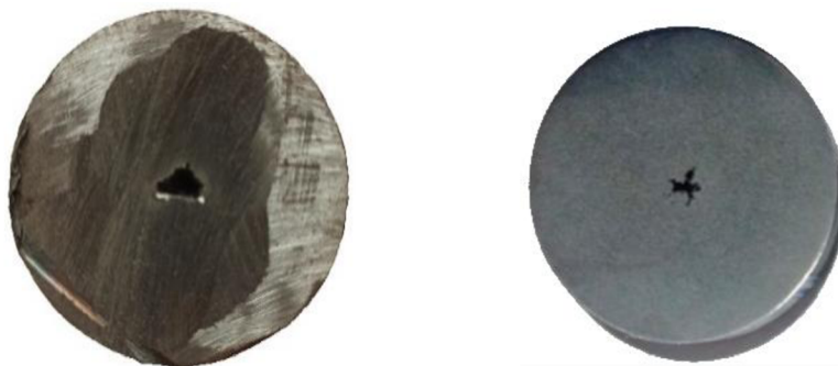
Obr. 31 Ukázka vnitřních trhlin [59].
