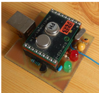
Obr. 6.9: DPS bezdrátové komunikace
