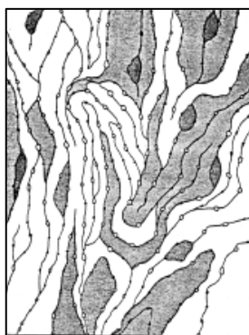
Obr. 4.14 Mikrostruktura prášku po konečném stádiu mletí typická pro ODS slitiny [39].
