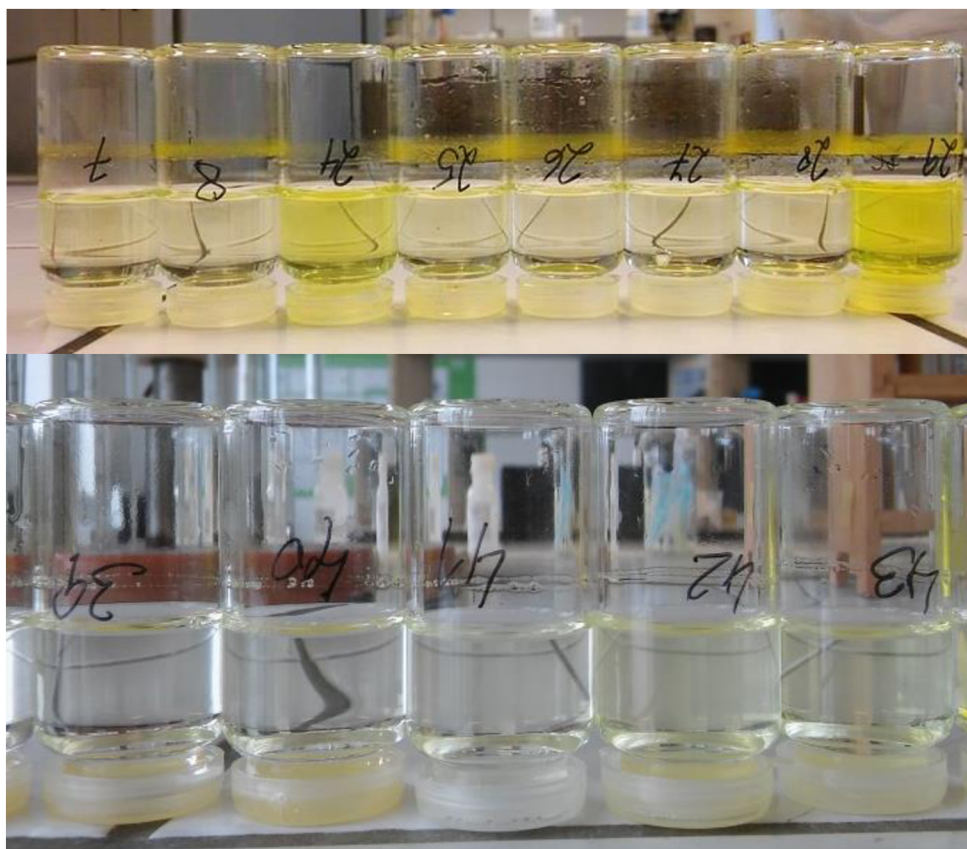
Obrázek 8: Mikrogel (zbarvený okraj na stěně vialek) připravený s tenzidem CTAB (nahore) a Septonexem (dole)
