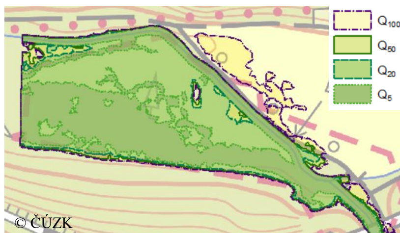
Obr. 38 Záplavové území – úsek od železničního mostu ke konci řešeného území
