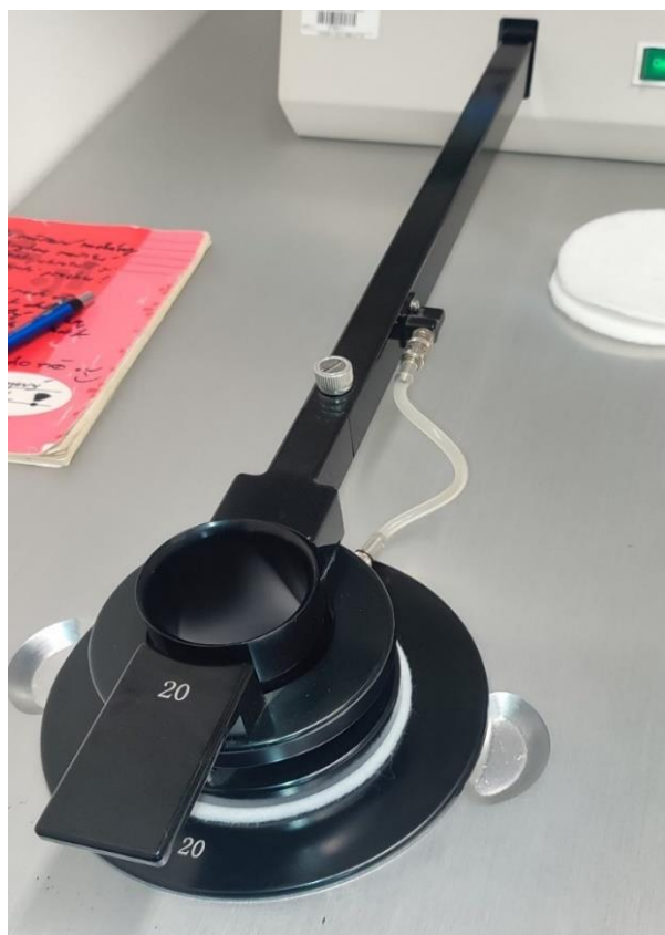
Obrázek 2.11: Testovací hlava s plochou 20 cm 2 přístroje SDL ATLAS MO21A
