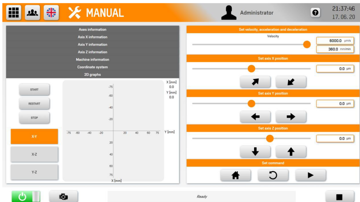
Obr. 10: Hlavní vizualizace – Strana „Manual“, manuální posuvy
