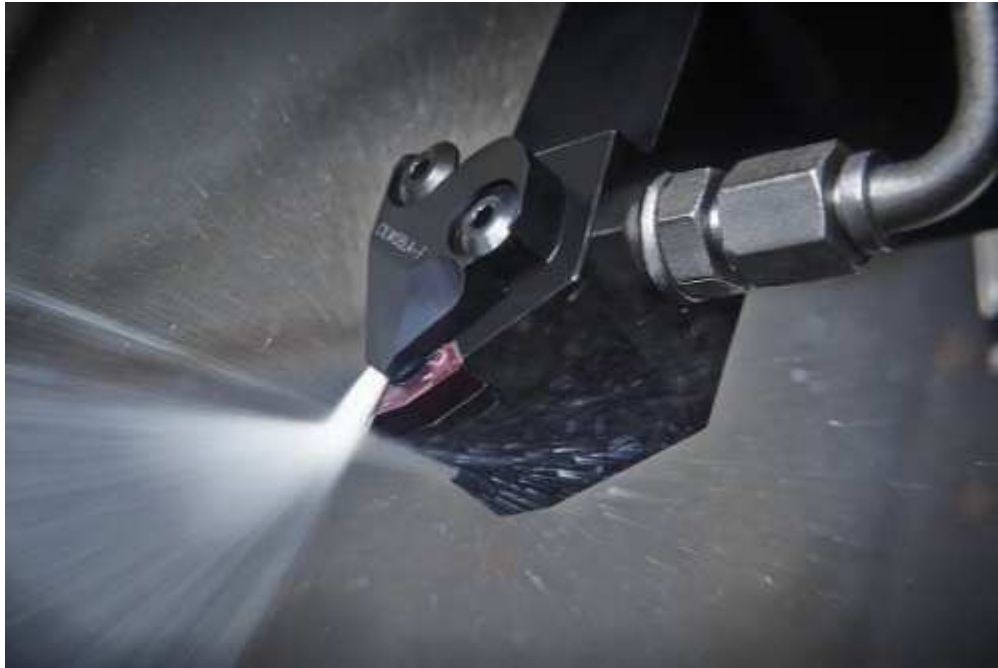
Obr. 10 Použití vysokotlakého chlazení u soustružnického nože [13].
