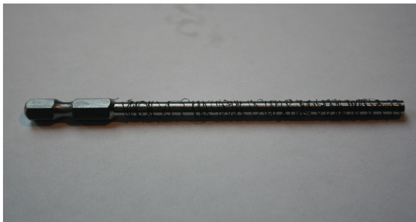
Obr. 45 Namotaná tříška na obrobku.
