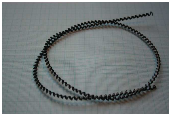
Obr. 24 Třísky při tlaku 10 MPa, konec životnosti.
