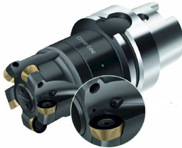
Obr. 11 Frézovací nástroj s tryskami pro vysokotlaké chlazení [14].
