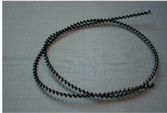
Obr. 24 Třísky při tlaku 10 MPa, konec životnosti.
