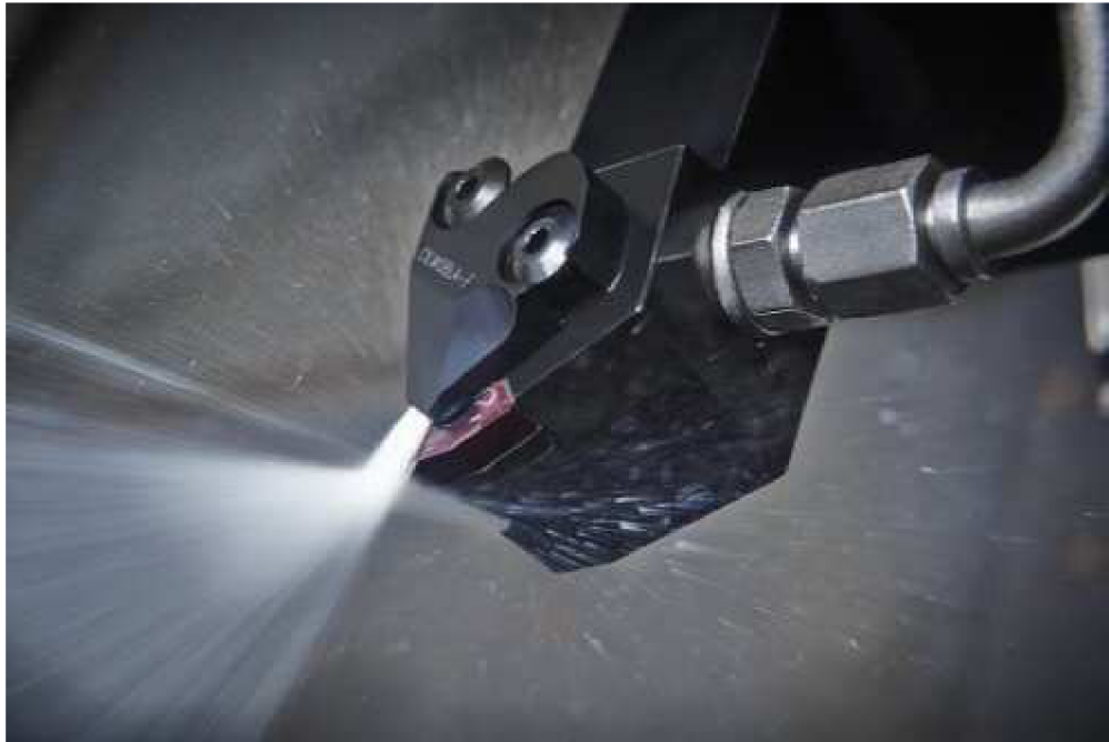
Obr. 10 Použití vysokotlakého chlazení u soustružnického nože [13].
