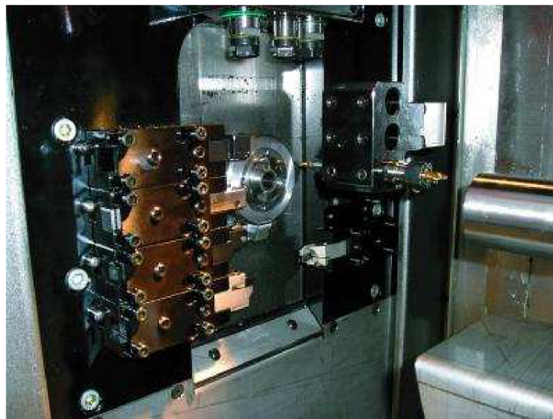
Obr. 13 Pracovní prostor dlouhotočného automatu [5].
