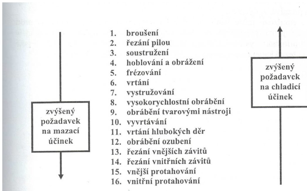
Obr. 5 Požadavky na kapaliny [1].
