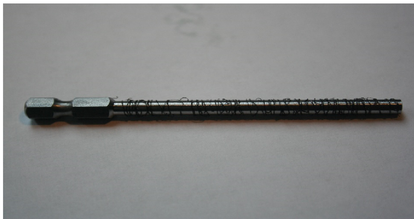
Obr. 45 Namotaná tříška na obrobku.
