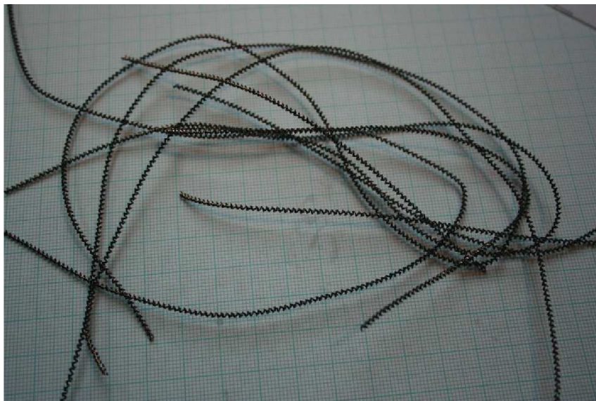
Obr. 40 Tříška při tlaku 5 MPa.
